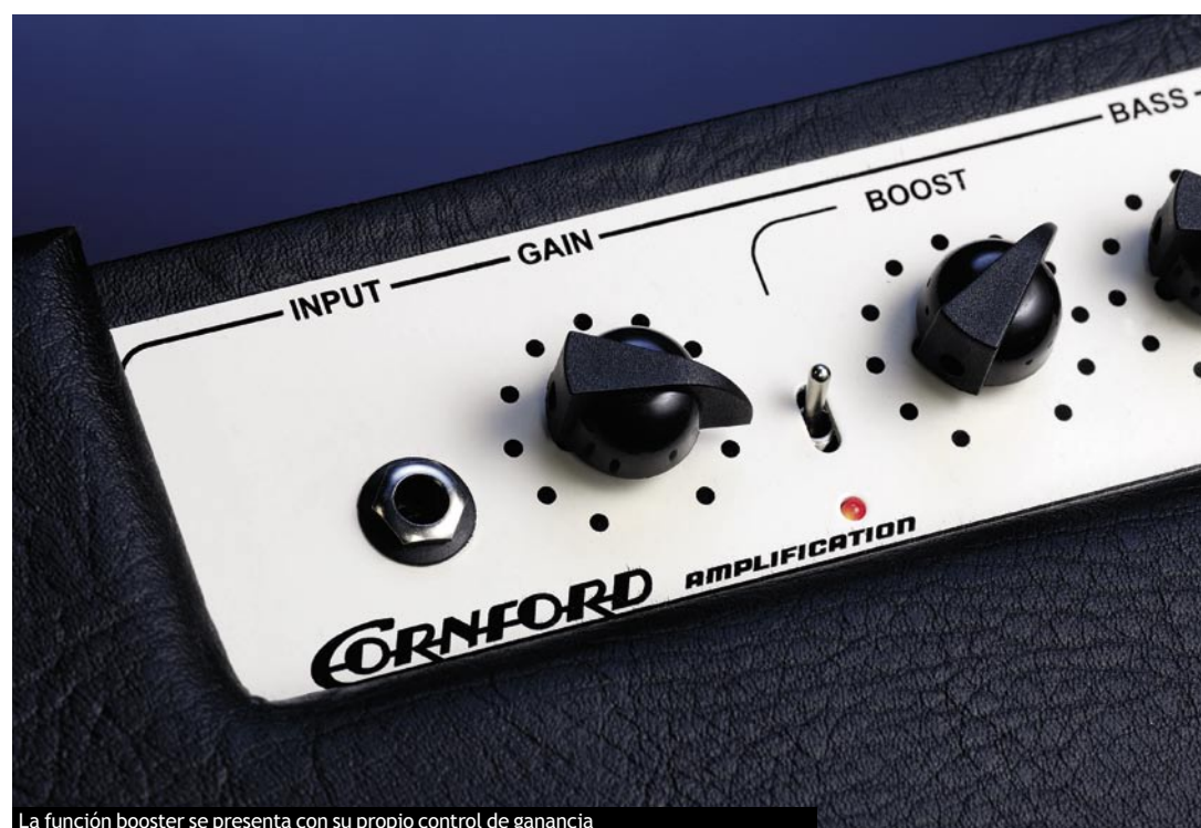
La función booster se presenta con su propio control de ganancia
