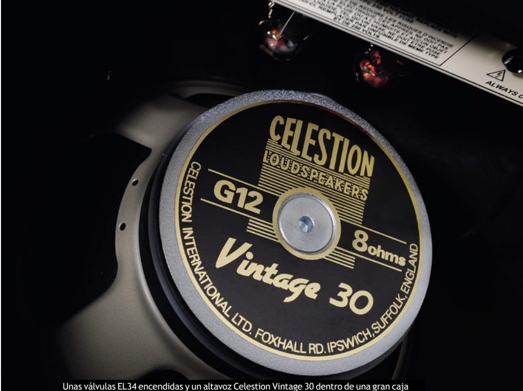
Unas válvulas EL34 encendidas y un altavoz Celestion Vintage 30 dentro de una gran caja
